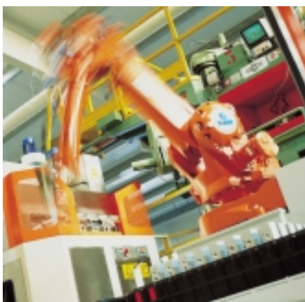
Рис. 3. Роботизированный технологический комплекс по изготовлению корпусов пневмораспределителей Camozzi
